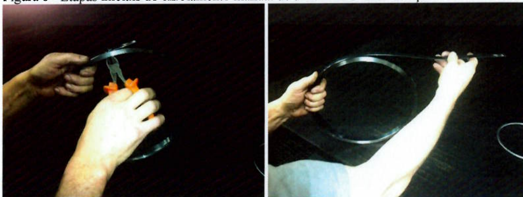
Figura 8 - Etapas iniciais do enrolamento manual de uma mola retrátil de aço.
