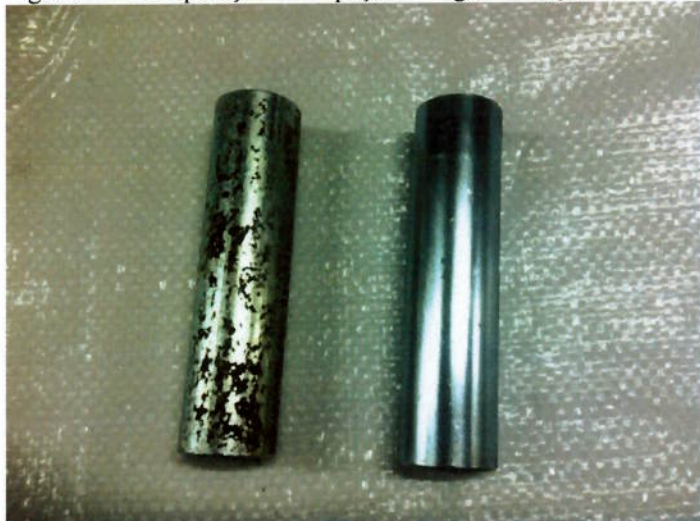
Figura 23 - Comparação entre peças com galvanização boas e ruins.
