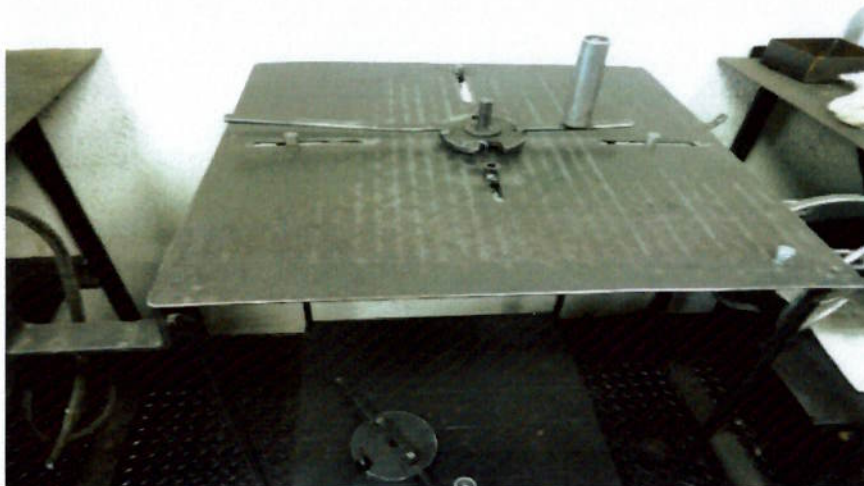
Figura 10 - Dispositivo para enrolamento de molas retráteis de aço.
